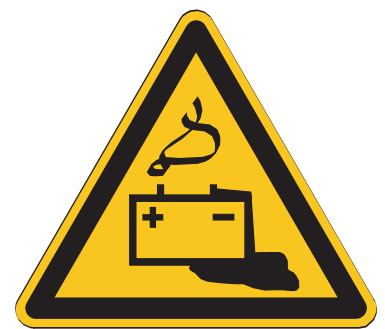
Warnung vor Gefahren durch Batterien (ÖNORM)
