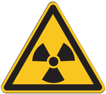
Warnung vor radioaktiven Stoffen oder ionisierenden Strahlen
