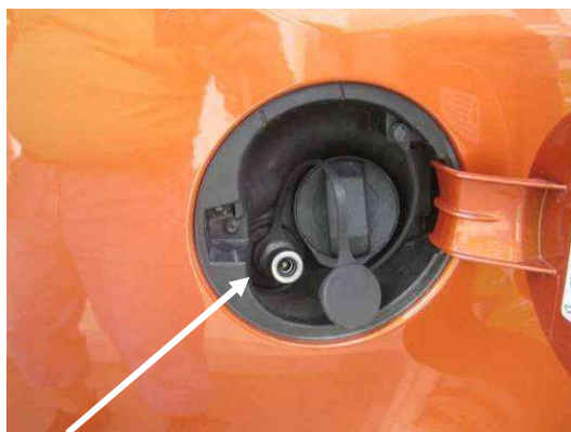
Erdgastankanschluss links neben „normalem“ Tankstutzen
